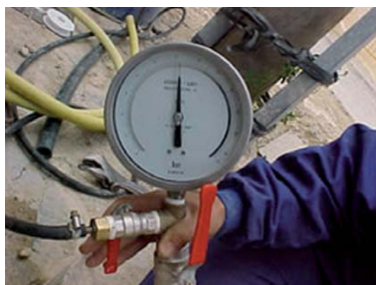
Manómetro de precisión calibrado para verificar las pruebas de presión de las instalaciones de abastecimiento de agua.
